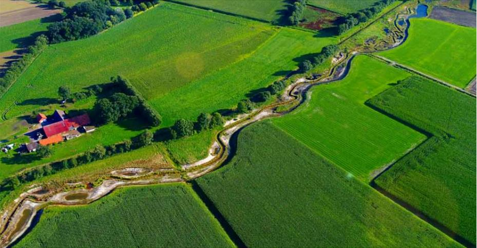
Nachempfinden einer sich unregelmäßig windenden Verlaufsform soweit möglich. Auch mehrarmige Abschnitte sind hilfreich. Keine gleichmäßige Sinuskurve anlegen! Die endgültige Linienführung muss vor Ort an die Gegebenheiten des Geländes angepasst werden. Den neuen Verlauf anlegen, sich eine Saison setzen lassen und dann erst anschließen!
